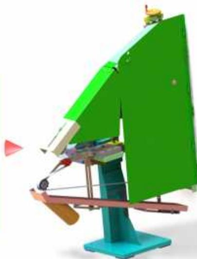
Предназначен для ручной полировки сложных криволинейных поверхностей с жесткими допусками (лопатки авиационных турбин; лопасти гребных винтов и пр.).
